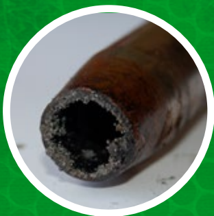
SIN PROTECCIÓN DESPUÉS DE LA SOLDADURA
